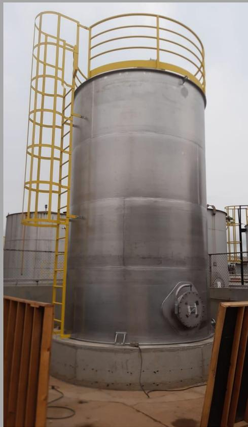
Tanque com capacidade para 35 mil litros em aço inox 304
