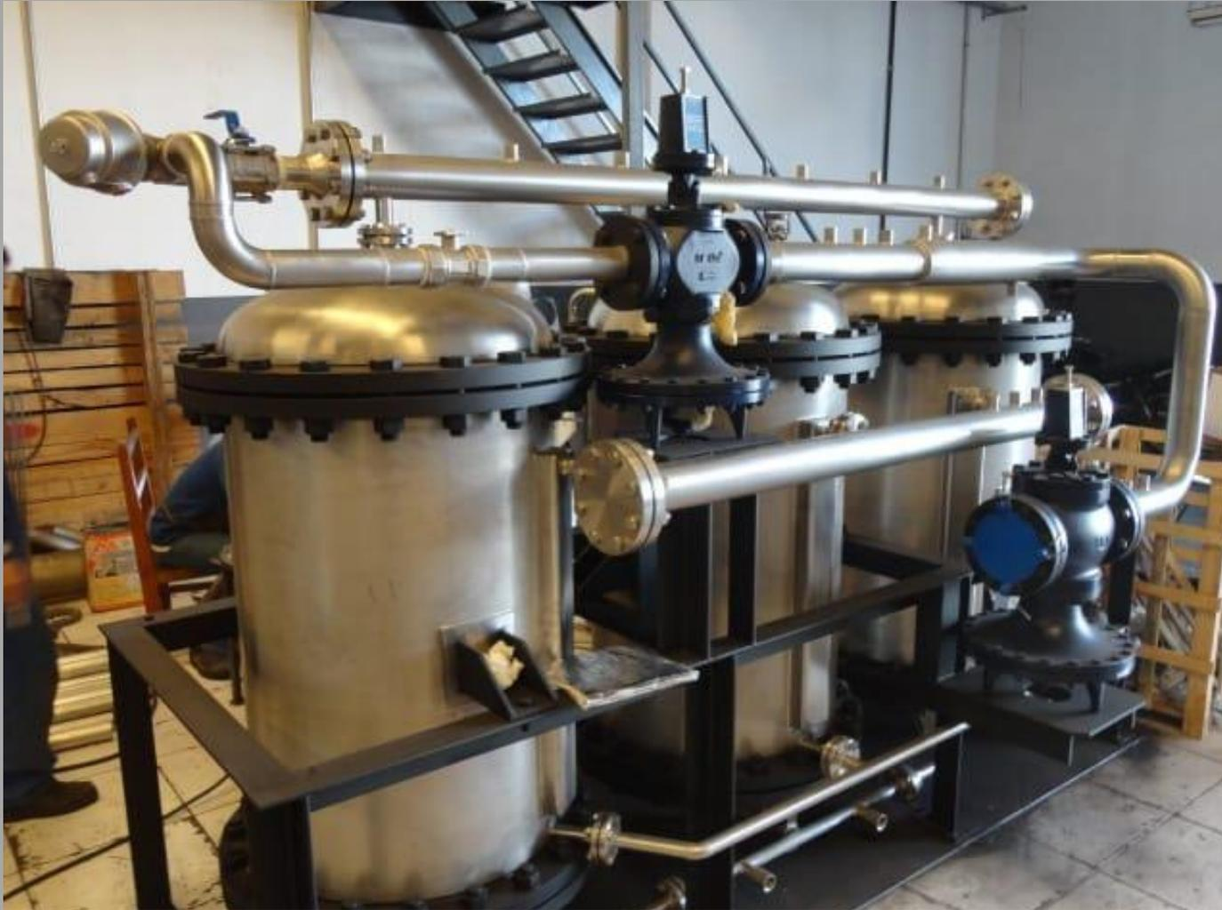
Conjunto de trocadores de calor para aquecimento de álcool, feito em inox 304.
