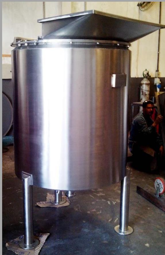
Tanque encamisado, em aço inox 304, com capacidade para 1000 kg
