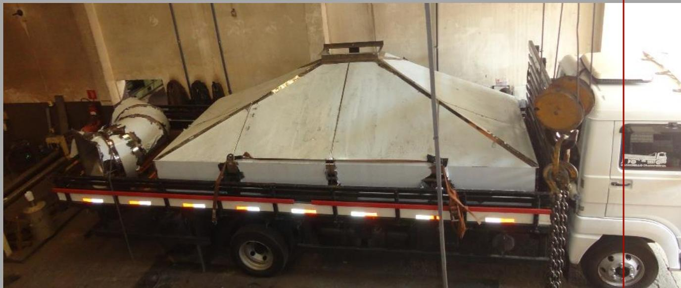
Coifa produzida em inox 304 polido, com dimensões de 4600 x 3100 x 1750 mm
