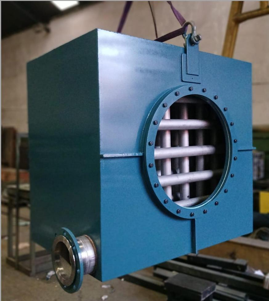
Trocador de calor com serpentina em aço inox e caixa em A36
