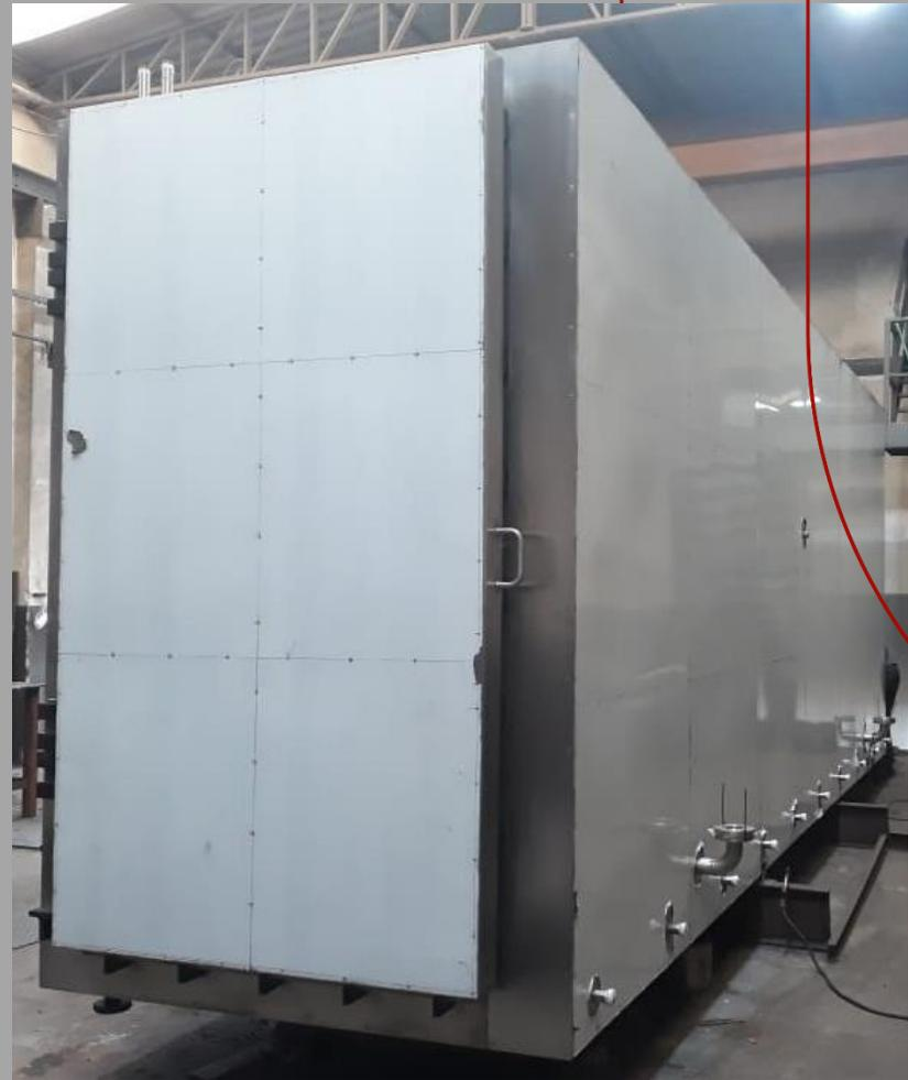
Autoclave em aço inox 304 com dimensões de 7500 x 2500 x 1300 mm
