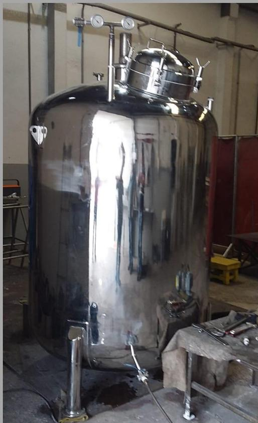
Tanque misturador de xarope em inox 316L
