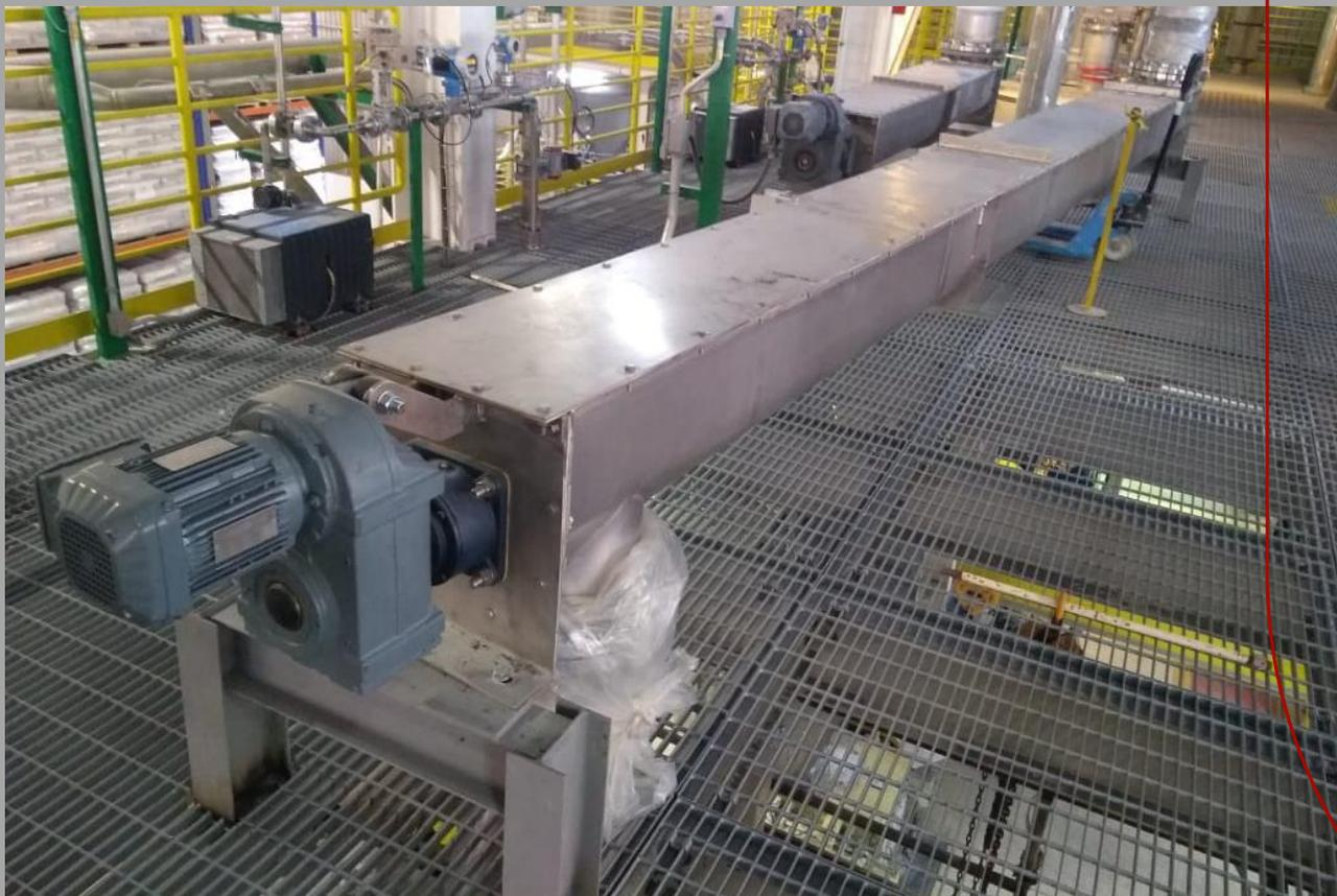
Rosca transportadora de sílica em inox 304 L, dimensões de  $\varnothing 320 \times 7000$ , com acionamento e calha tipo cocho
